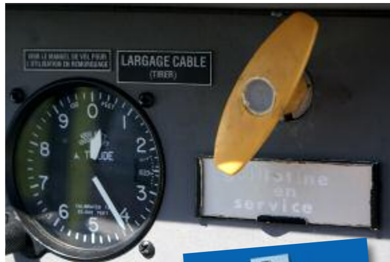
Bien savoir localiser la poignée de largage ou la guillotine de l'enrouleur...
